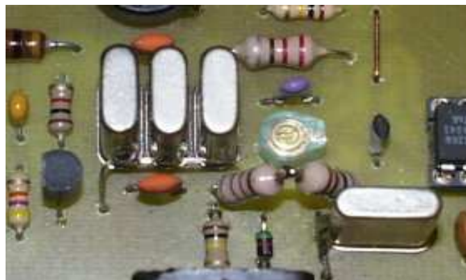
Detail spájkovania kryštálov do medzifrekvenčného filtra
